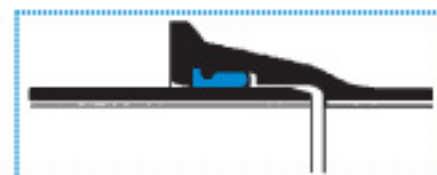
Giunto rapido * Tyton * DIN 28600 accettato dalla EN 545 e dalla EN 598.
